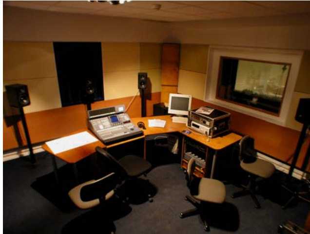
2. ábra: Modern akusztikai burkolatok a BME Híradástechnikai Tanszék stúdiójának technikai helyiségében
